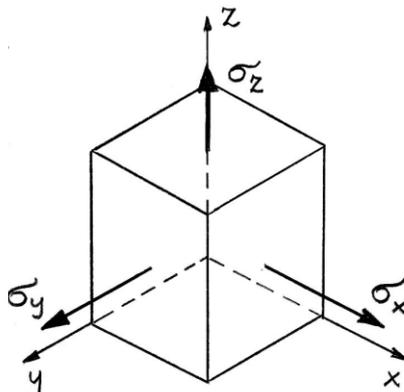
Possono produrre *trazione* (tensioni positive) o *compressione* (tensioni negative).
