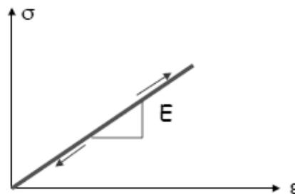
La teoria dell'elasticità non è sufficiente a descrivere in maniera compiuta il comportamento reale dei terreni → non è in grado di descrivere le deformazioni permanenti che si evidenziano nei terreni quando si arriva a rottura → teoria della plasticità
