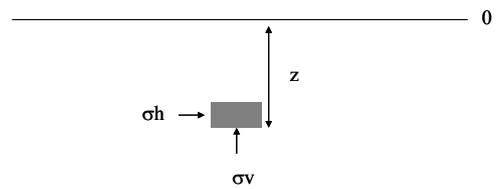
1) Se a partire da una condizione di equilibrio si provoca un avvicinamento delle superfici verticali (sotto l'azione di un utensile) ne consegue un aumento della tensione  $\sigma_h$  mentre resta costante  $\sigma_v$ .
