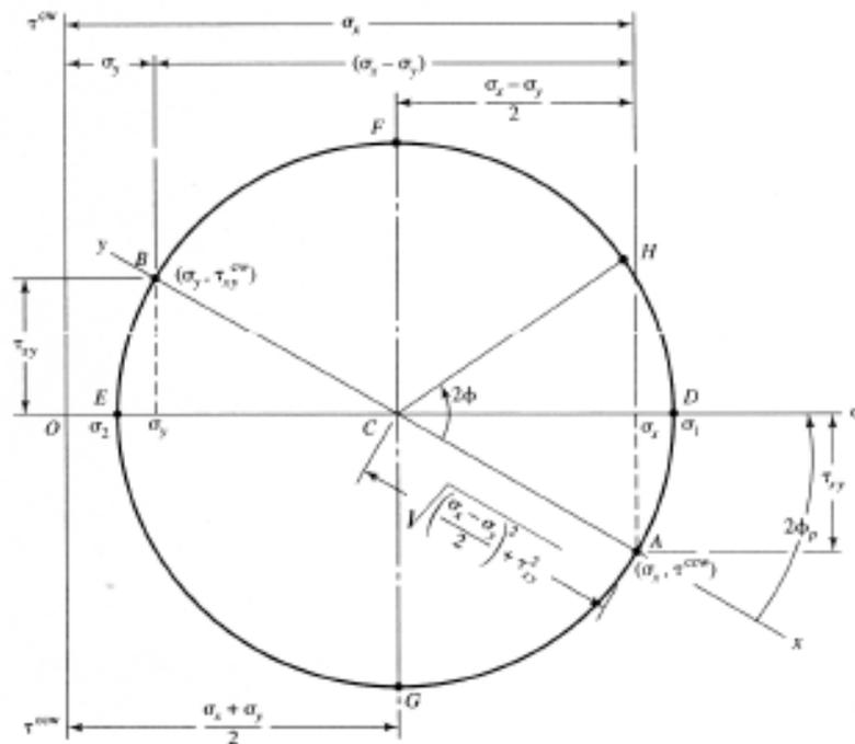
I punti disposti a  $180^\circ$  l'uno rispetto all'altro sul cerchio di Mohr rappresentano lo stato tensionale su due facce a  $90^\circ$  dell'elementino. Le intersezioni del cerchio di Mohr con l'asse delle  $\sigma$  individuano le tensioni principali.
