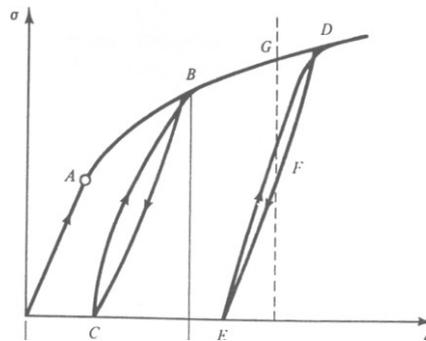
Incrementando il carico gradualmente, il materiale manifesta un comportamento di tipo elastico fino al punto A → il materiale recupera la sua configurazione iniziale quando il carico esterno viene rimosso.
