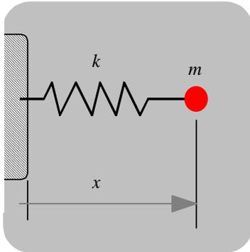
supponiamo che la massa  $m$  si muova in un mezzo viscoso e scriviamo l'equazione del moto lungo l'asse  $x$ :  $F=m \cdot a$ . Sulla massa  $m$  intervengono due sole forze, il richiamo della molla e l'attrito: se si ipotizza che la molla sia a comportamento elastico lineare allora l'azione di richiamo vale  $-k \cdot x$ , mentre se si ipotizza che il fluido che circonda la massa  $m$  (per esempio l'aria) abbia comportamento viscoso, allora la forza resistente vale  $-h \cdot Vx$ :
