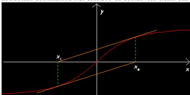
Con il metodo di Newton non serve più isolare la radice, ma basta esplorare il dominio successivamente con un passo sempre più piccolo, usando diversi punti come innesco del metodo.
