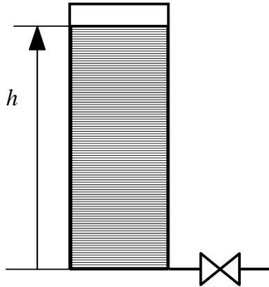
La velocità  $w$  con cui il fluido defluisce dal tubo di uscita può essere facilmente ricavata applicando il teorema di Bernoulli:
